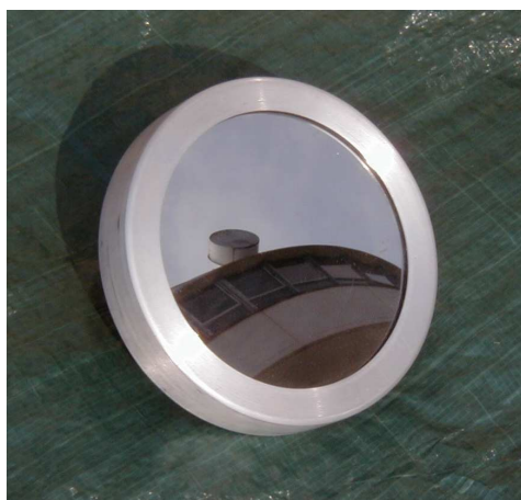
filtre pleine ouverture transmettant 1/100 000 ème de la lumière dans l'instrument
