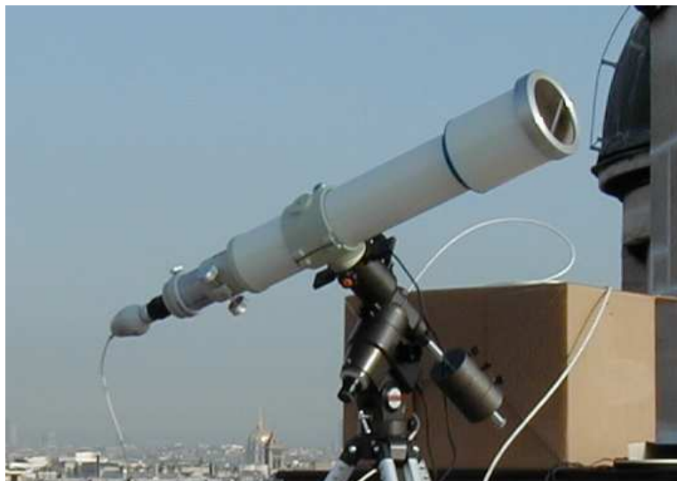
Webcam au foyer d'une lunette de 820 mm de distance focale munie d'un filtre pleine ouverture
